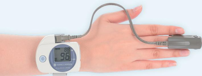
検査機器(パルスオキシメータ)を指に装着して寝ることで、睡眠時における動脈酸素飽和度(SpO2)と脈拍数を測定し、睡眠時無呼吸症候群の可能性を判定する簡易的な検査です。
